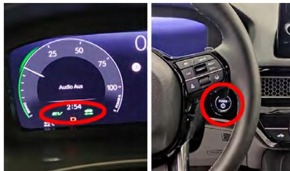
Puis, retirer la clé électronique et la maintenir à au moins 5 m du véhicule
