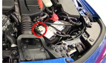
**2. Désactiver le système haute tension dans le compartiment du moteur**
