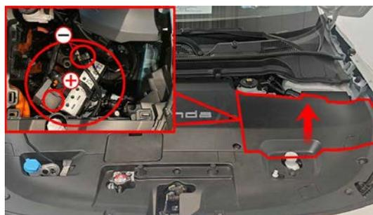
**2. Desativação do sistema de alta tensão no compartimento do motor**
