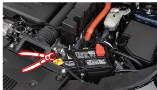
**2. Désactiver le système haute tension dans le compartiment du moteur**
