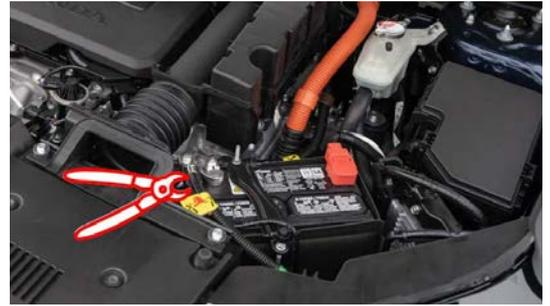
**2. Se puede desactivar el sistema de alta tensión en el compartimento del motor**
