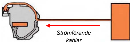
Strömflöde från batteri till AC-kompressor
