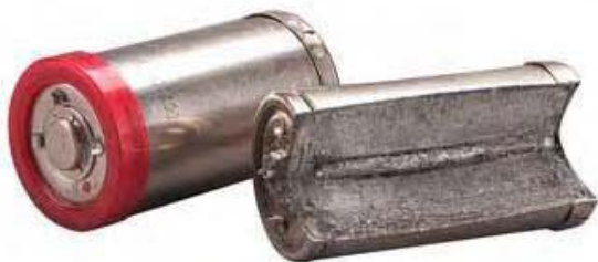
Elektrolyten i högsäpänningsbatteriets celler är av icke-flytande typ och bör därför inte utgöra någon risk.
