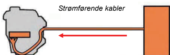
Strømførende kabler Strøm løber fra batteriet til elmotoren
