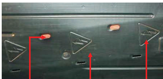
Cable de alto voltaje visible
