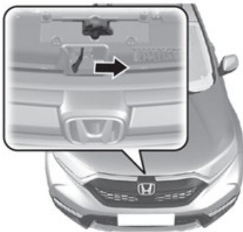
3. Quite o corte el cable del lado del terminal negativo (-) de la batería de 12 V.
